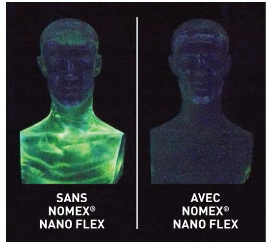
Photographies à UV sans Nomex® Nano Flex (à gauche) et avec Nomex® Nano Flex (à droite) : illustrations après une exposition aux particules pour la tête et le cou du sujet du test ; les zones en jaune vif montent là où les particules ont pénétré l'ensemble.
